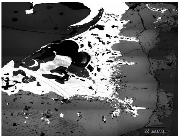
Fig.4.3. Cazul interacției A.C.M.-O.C.F.S: 1-oțel; 2-A.C. penetrat.
